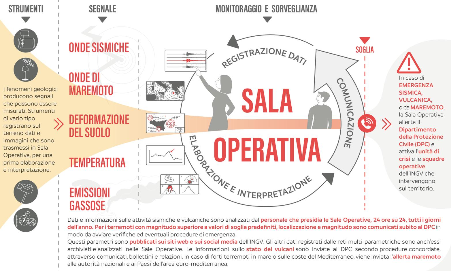
I fenomeni geologici producono segnali che possono essere misurati. Strumenti di vario tipo registrano sul terreno dati e immagini che sono trasmessi in Sala Operativa, per una prima elaborazione e interpretazione.
